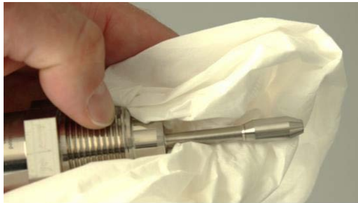
溶剤で濡らした布または紙でセンサーを洗浄する
